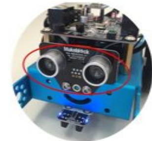
Capteur Ultrasons : capte la distance de l'obstacle.
