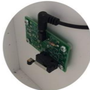
Le micro-rupteur à galet est contacté quand la porte s'ouvre et « appuie sur le galet »
