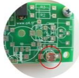
LDR (capteur de lumière) capte la variation de luminosité tout au long de la journée.
