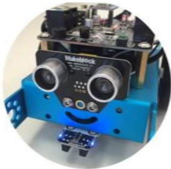
Capteur Ultrason : détection d'obstacle
