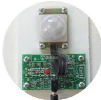
Capteur infrarouge : détection des personnes
