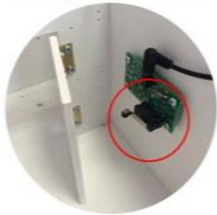
Le microinterrupteur à galet détecte si la porte est ouverte ou fermée
